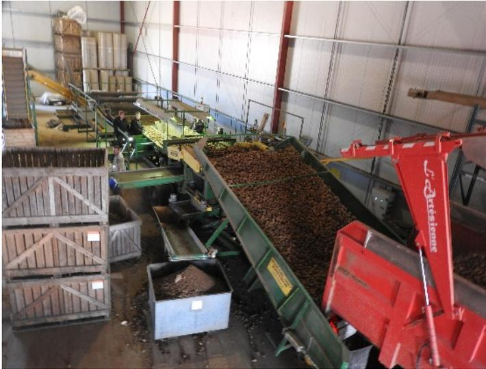
Elles passent sur des tamis dont les écartements sont différents (3), permettant de les trier, Ce tri étant complété par un procédé optique (4), Puis elles sont ensachées (5) et stockées en chambre froide (6), jusqu'à livraison.
